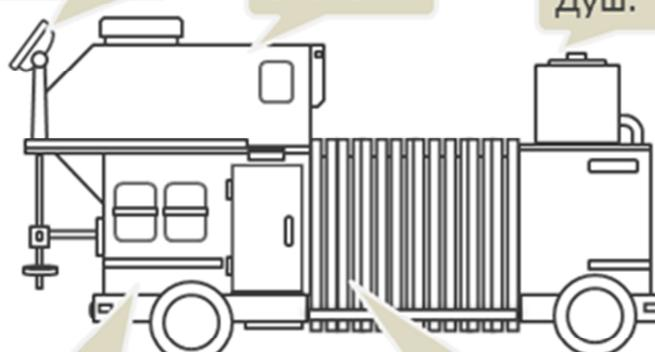
В сложенном виде модуль мы привозим на строительную площадку. Потом раскрываем и получаем длинный вагон, где есть столовая, место для просмотра телевизора, душ, а наверху спальня.
